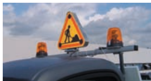
Lampeggianti segnalazione lavori in corso (triangolo AK5 + girofaro)
